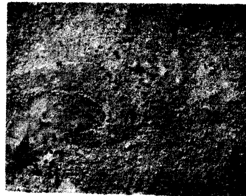
Рис. 23. Диффузионная ширина границы зерна (самодиффузия в никеле, 1000 °С, электронно-микроскопическая автордиограмма, X3400)
