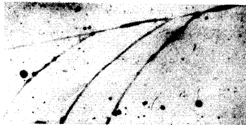
Рис. 67. Следы движущейся границы в бикристалле цинка
