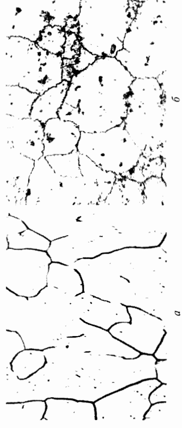
Рис. 4.17. Неоднородность микроструктуры к концу первичной рекристаллизации после холодной (а) и горячей (б) деформации
