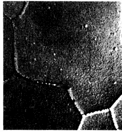
Рис. 4.6. Высокоугловая граница как хороший геттер
