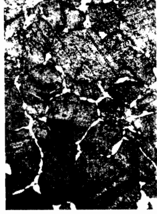
Рис. 13.5. Микроструктура феррита с примесью, образующей легкоплавкую эвтектику, после жидкофазного спекания и охлаждения
