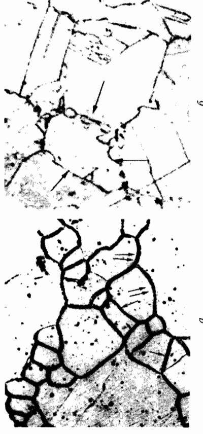
Рис. 4.15. Предпочтительные места образования зародышей рекристаллизации (а, б) и форма зародышей (а)
