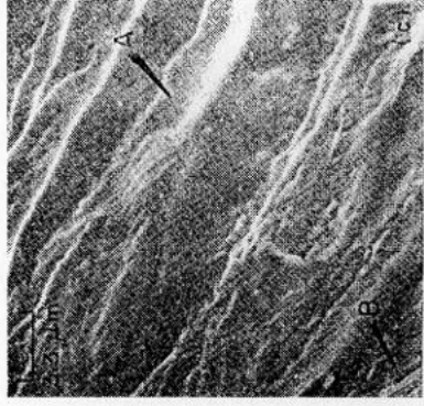
Рис. 22. Скол в сочетании с усталостными бороздками. Между ступеньками скола можно обнаружить тонкие усталостные бороздки А и В, показанные стрелками. а) Увеличение – \times 300 , с) Увеличение – \times 3\ 000 .
