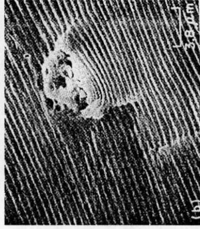
Рис. 19. Усталостные бороздки в алюминиевом сплаве 2024-Т3
