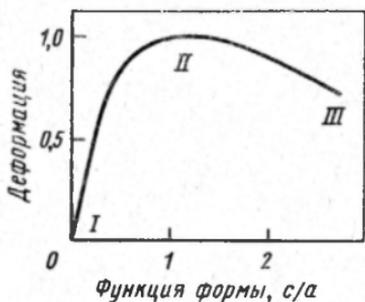
Рис. 10. Зависимость энергии упругой деформации (условные единицы) матрицы  $g_e$  от соотношения половины толщины  $c$  и радиуса  $a$  некогерентного выделения, имеющего форму сфероида: I — диск; II — сфера; III — игла
