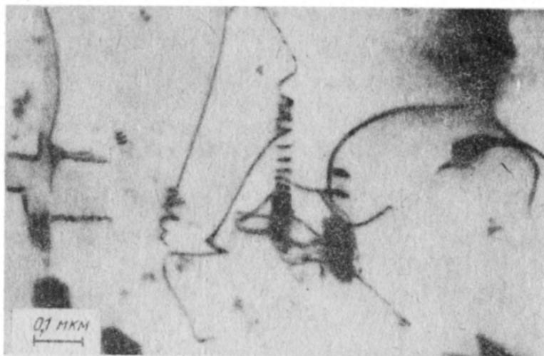
Рис. 6. Электронная микрофотография выделений железохромистых карбидов (типа  $M_{23}C_6$ ) в аустенитной нержавеющей стали, состаренной при температуре  $750^\circ\text{C}$  в течение 5,5 ч. Растущие частицы выбивают в матрицу призматические дислокационные петли [Lewis, Hattersley]
