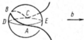
Рис. 116. Переползание дислокации, охватывающей сферическую частицу
