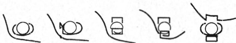
Рис. 50. Схема поперечного скольжения дислокации через выделение [Hirsch, Humphreys]
