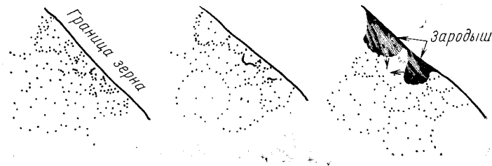
Рис. 3.30. Зарождение центров рекристаллизации посредством роста субзерен.
