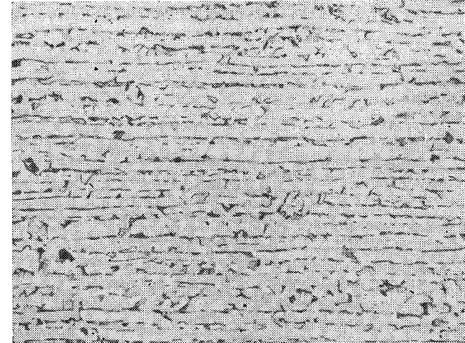
Рис. 2.9. Микроструктура отожженной пластины из промышленной малоуглеродистой стали с отчетливо выраженными слоями перлита
