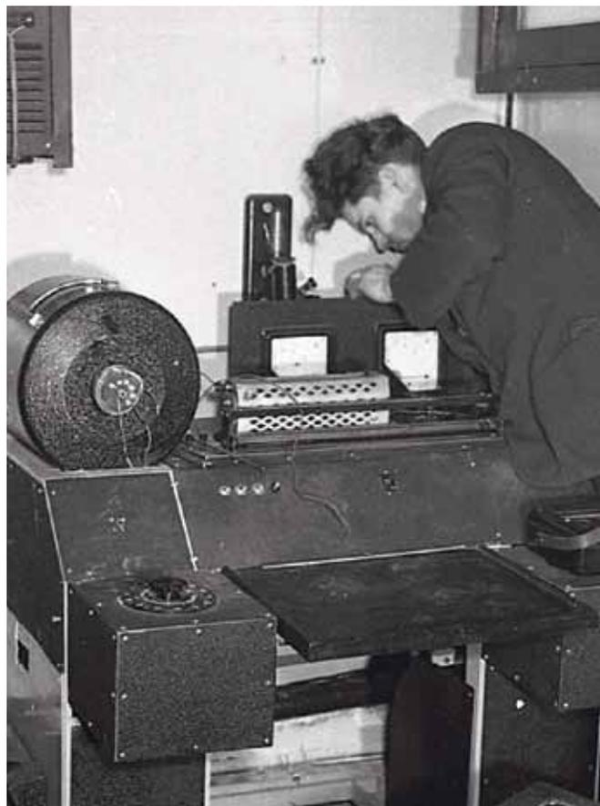
Модернизированная дипольная магнитометрическая установка (МАГ-56Д) для исследования кинетики фазовых превращений в сплавах при высоких и низких температурах.
