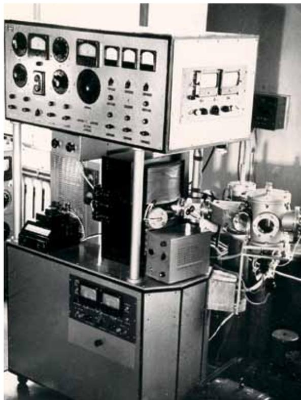
Ионно-лучевая установка УИ-15. Разработана и изготовлена в ГИФТИ в 1963–1969 гг. Была внедрена в ИТМиВТ АН СССР.
