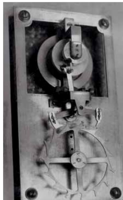
Макет модернизированного анкерного хода часов с несимметричной анкерной вилкой
