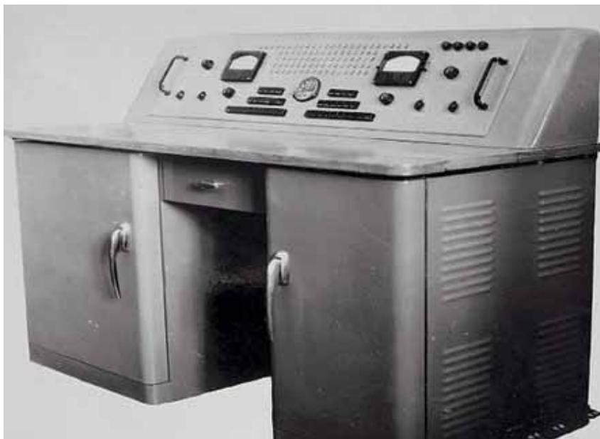
Система цифрового управления радиотелескопами НИРФИ «СПУРТ»
