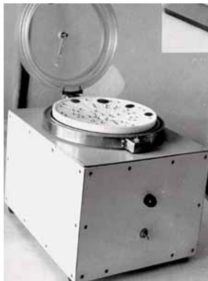
Установка центрифугирования для осушки подложек полупроводников. Разработчик Л.И. Яснева
