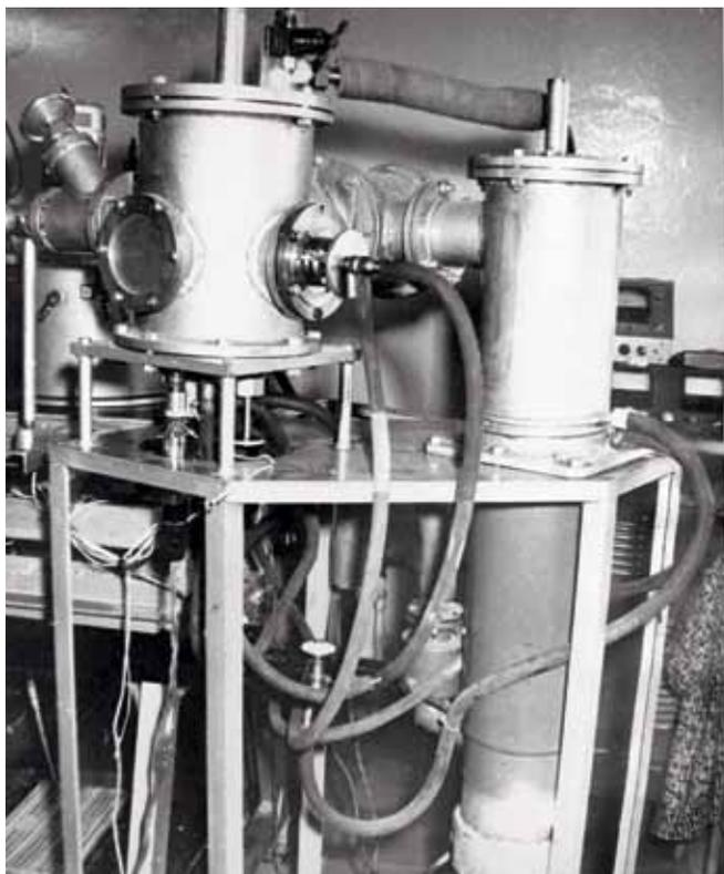
Коллекторное устройство специализированной ионно-лучевой установки для легирования полупроводников (установка разработана и создана в ГИФТИ). 1961–1963 гг.
