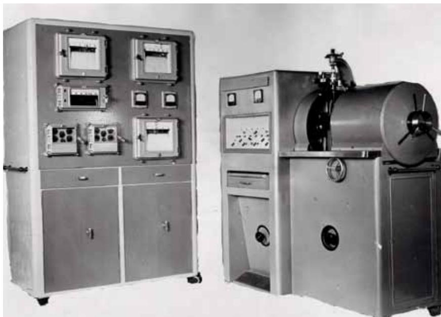
Дипольная магнитометрическая установка (МАГ-65Д) с программным управлением для исследования кинетики фазовых превращений в сплавах.
