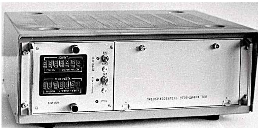
Многоразрядный преобразователь цифра – угловой код для работы с антенными системами, оснащенными аналоговыми датчиками обратной связи типа СКВТ. Преобразователь выпускался заводом «Микроприбор» (г. Львов), опытный образец сборки ПЛ ЭВМ показан на фото
