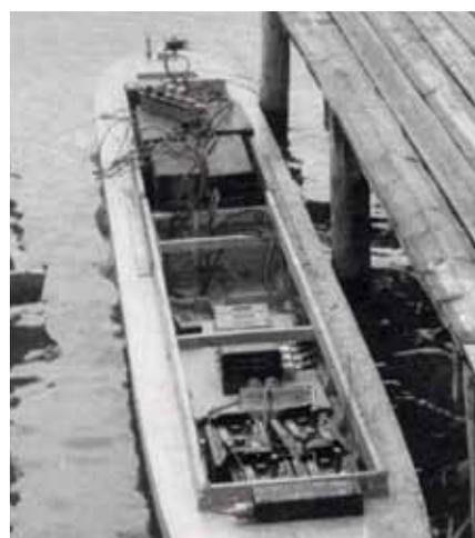
Приемная часть аппаратуры, установленная на модели судна
