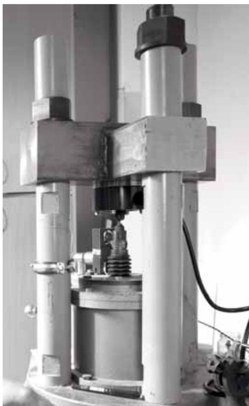
Система для определения и оценки комплекса характеристик прочности и вязкости сплавов при комнатной температуре при испытании миниатюрных образцов
