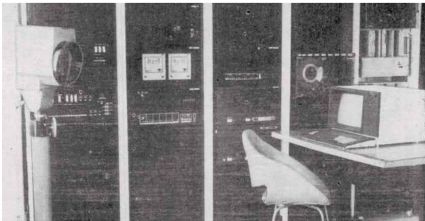
Комплекс тепловизионного ввода и обработки ИК-изображений, применяемый для экспериментального исследования нестационарных тепловых полей
