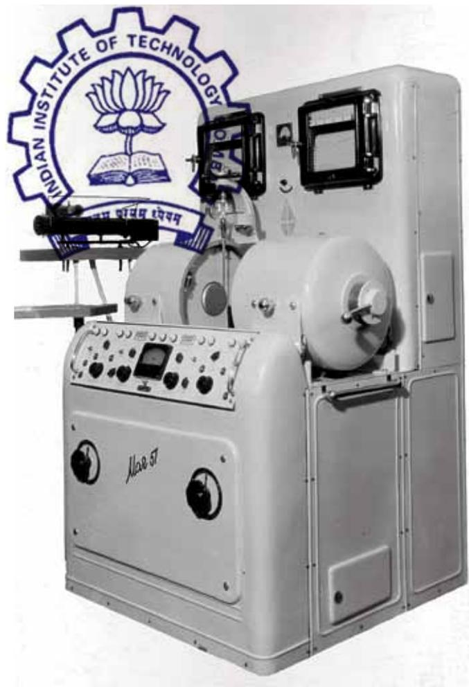
Модернизированная дипольная магнитометрическая установка (МАГ-57Д), изготовленная для Бомбейского политехнического института (Индия). Разработчики: Б.А. Апаев, Л.Н. Борисевич, В.А. Аброськин, В.А. Дозоров, А.И. Успенская
