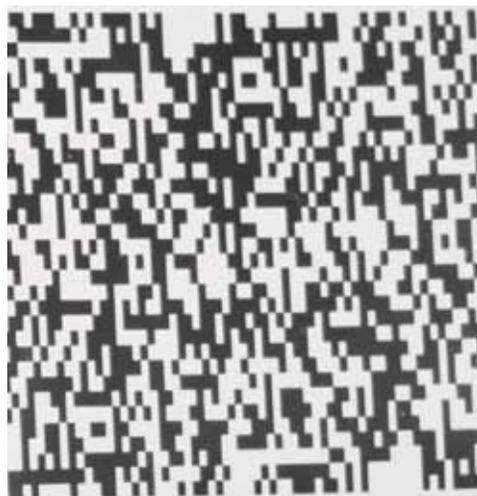
Маска рандомизирующая (PM). Обеспечивает высококачественную запись информации голографическим методом. PM внедрена в производство при изготовлении изделий оптической памяти
