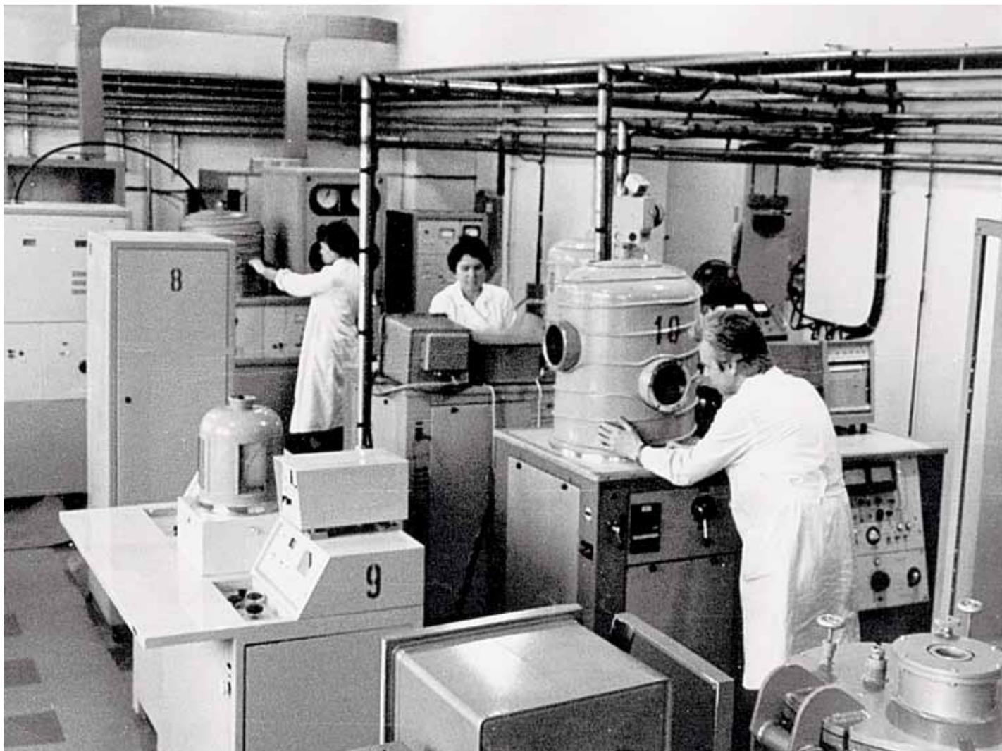
В состав лаборатории вошла группа, руководимая к. ф.-м. н. Ю.Д. Панковым. Коллектив лаборатории выполнял большой объем работ в области низкотемпературных плазмохимических методов синтеза диэлектрических покрытий из элементарно-органических соединений. В лаборатории была создана уникальная аппаратура и технология синтеза пленок двуокиси кремния ( $\text{SiO}_2$ ) и нитрида кремния.
