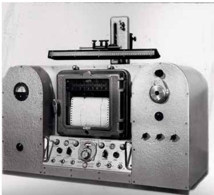
Баллистическая магнитометрическая установка (МАГ-58Б) для исследования кинетики фазовых превращений в сплавах при отпуске и количественного определения фазового состава. Разработчики: Б.А. Апаев, Б.М. Яковлев
