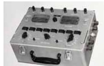
Система СПУ-2 для управления антенными комплексами
