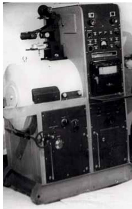
Пондеромоторная магнитометрическая установка (МАГ-54) с повышенной чувствительностью измерительной схемы для исследования кинетики фазовых превращений в сплавах при повышенных и низких температурах.
