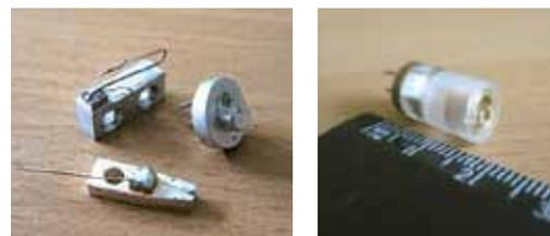
Вид изготовленных лазерных диодов новых конструкций
