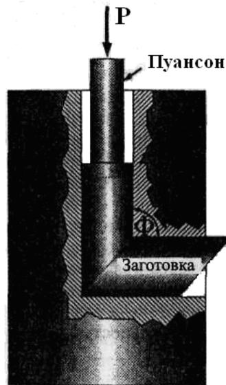
Рисунок 1.1.1 Схема формирования НМК структуры методом РКУП.
