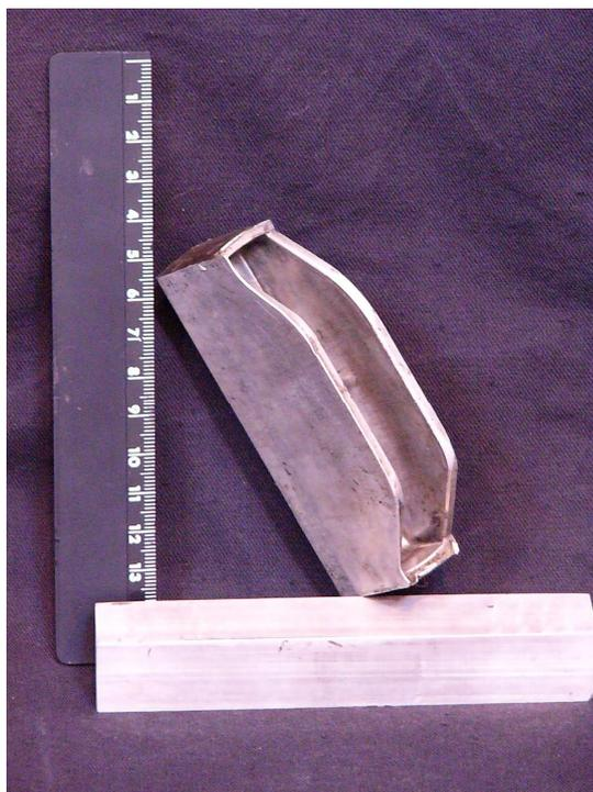
Рисунок П4 Высокопрочный микрокристаллический магниевый сплав ZK60. Деталь изготовлена объемной штамповкой (скорость - 1 мм/с, температура - 240 °С)
