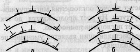
Рис. 2.3. Схема полигонизации: а – хаотическое распределение краевых дислокаций в деформированном кристалле; б – дислокационные стенки после полигонизации
