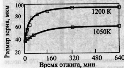
Рис. П1.2. Влияние времени выдержки на размер зерна никеля при двух температурах отжига
