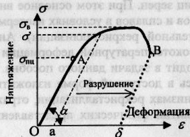
Рис. 1.2. Диаграмма зависимости деформации металла от действующего напряжения
