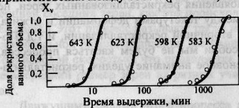
Рис. 3.1. Кинетика первичной рекристаллизации при разных температурах в алюминии чистой 99,96 % после растяжения на 10 %
