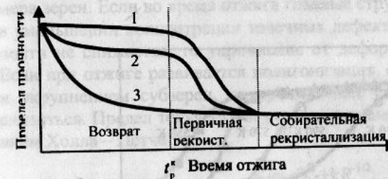
Рис. П2.1. Схема зависимости прочностных свойств деформированного металла от времени изотермического отжига
