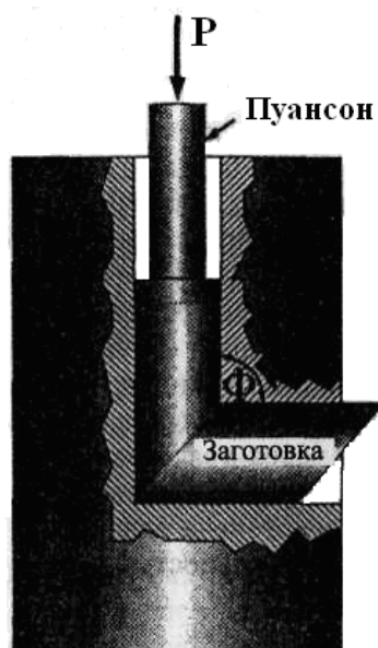
Рис. 3.1.1. Схема формирования нано- и микрокристаллической структуры методом равноканального углового прессования
